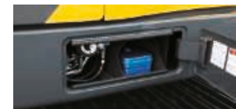
Schówek pod kabiną
